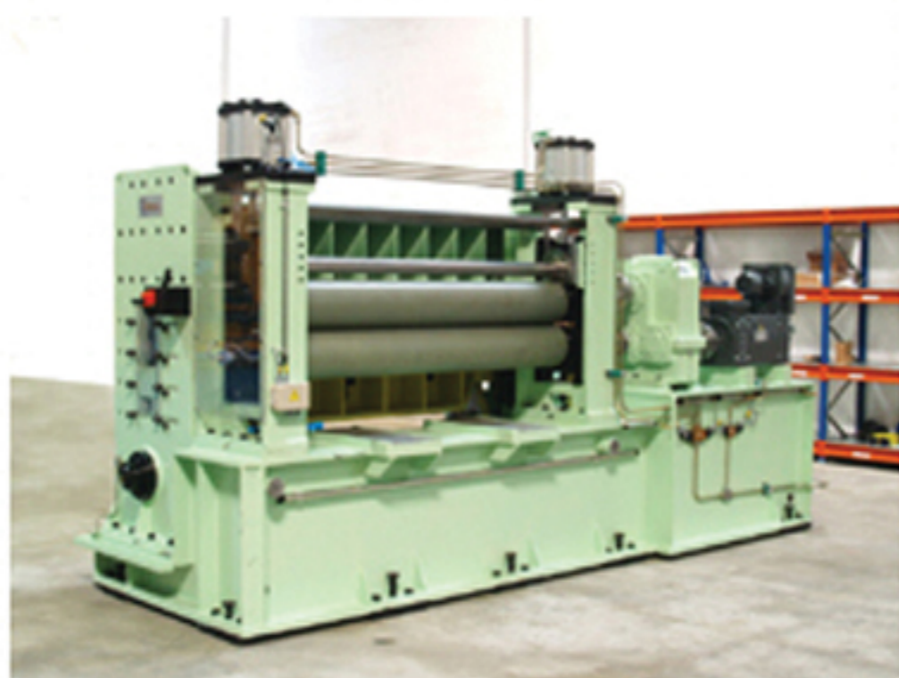
Detalle Rodillos Alimentadores de la Cizalla Electrónica (foto ilustrativa)
