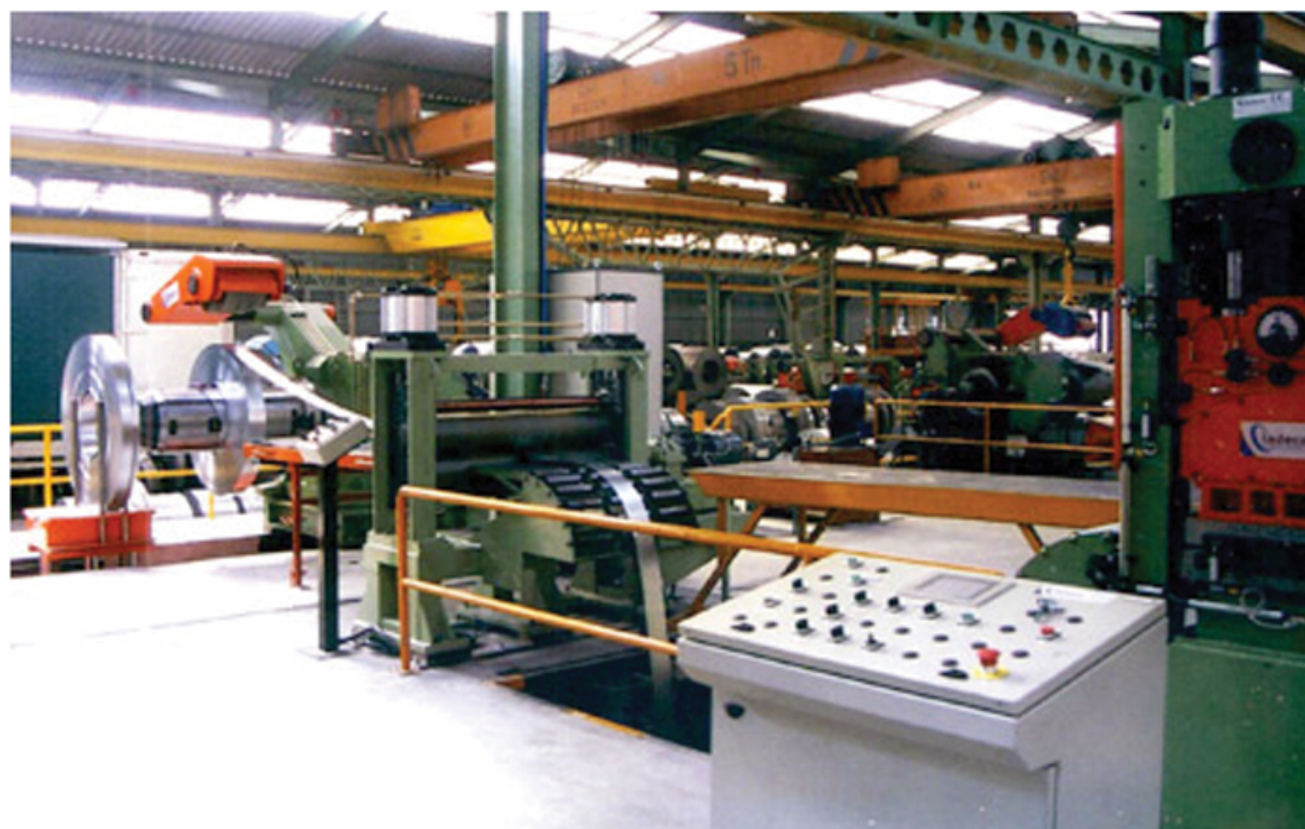
2.- Rodillos alimentadores para línea de corte transversal de 0,5 a 2 mm. espesor y 1.250 mm. de ancho.
