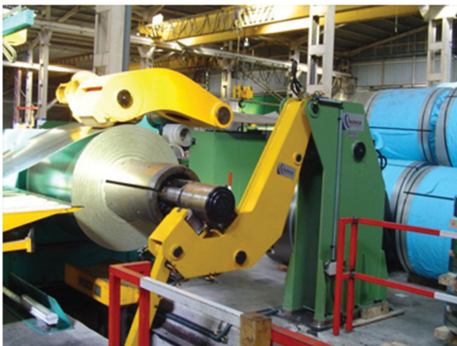
7.- Apoyo de mandrino escamoteable para bobinas de 20 Tm. de peso.
