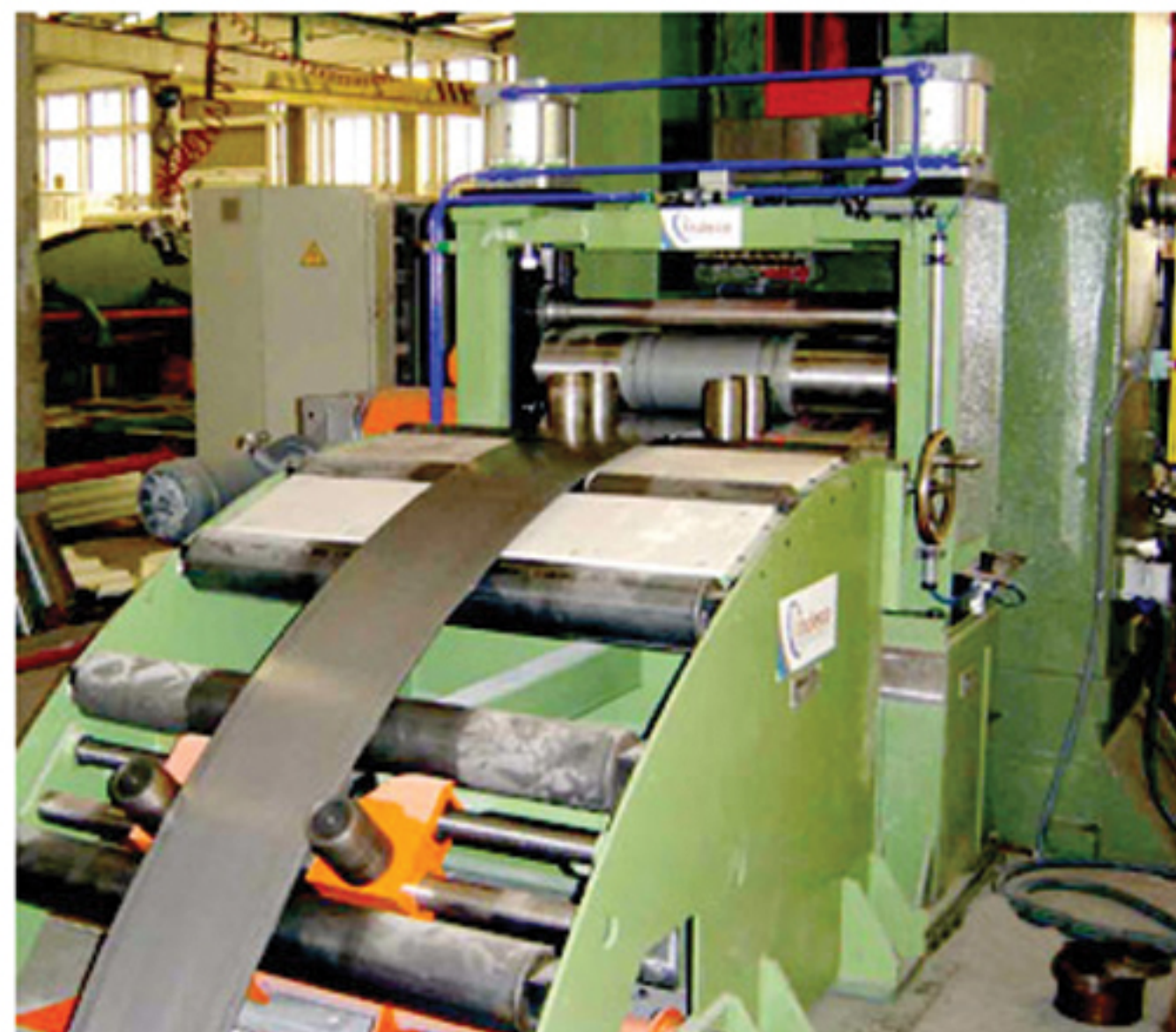
4.- Rodillos alimentadores con guías verticales para fleje de 3 mm. espesor y 600 mm. de ancho.
