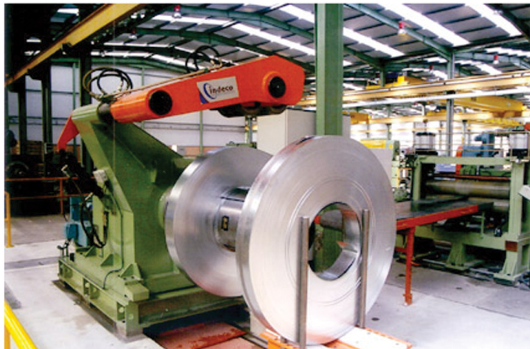
3.- Desenrollador con generador freno para bobinas hasta 1.250 mm. de ancho y 15 Tm.
