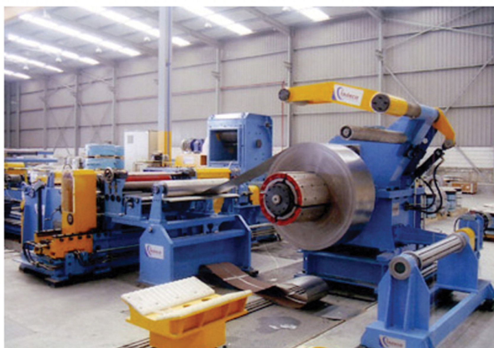
15.- Dérouleur pour diamètre intérieur de 508/610, avec générateur frein pour bobines de largeur 1.250 mm. et 15 t. de poids.
