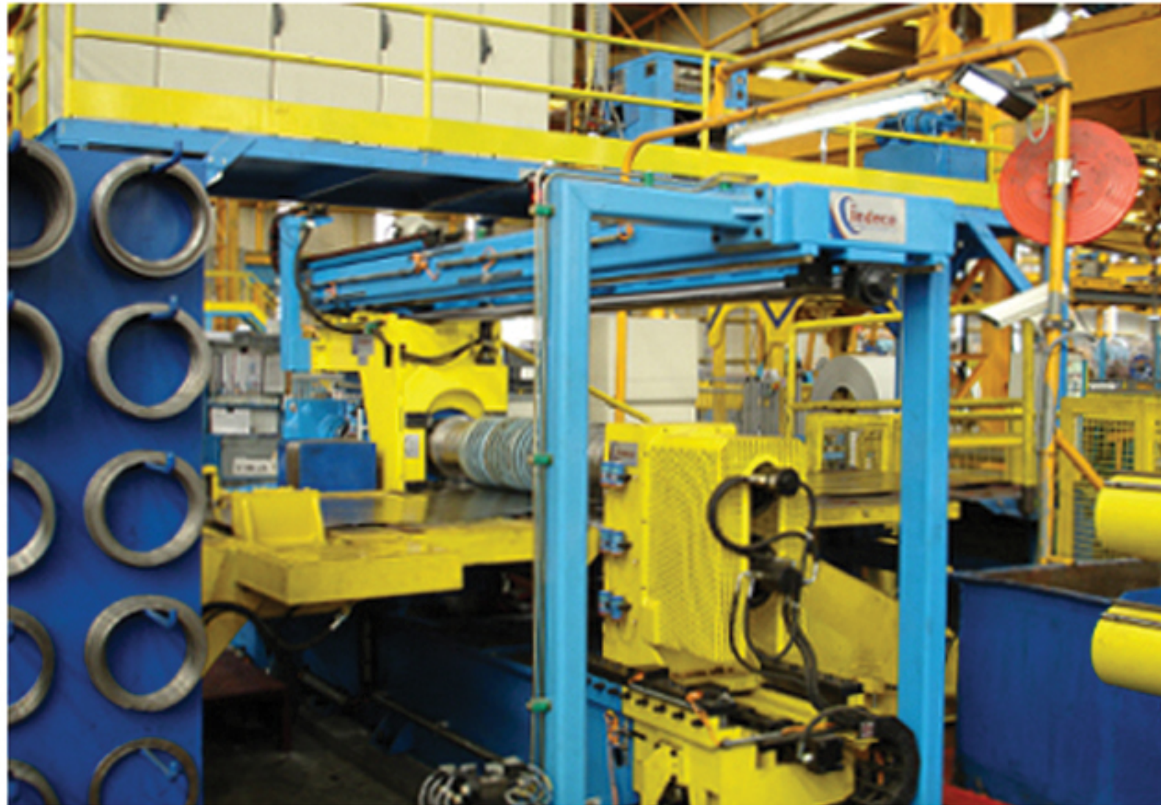
4.- Ligne de Refendage de 1500 mm. x 6 mm. x 200 m/min.
