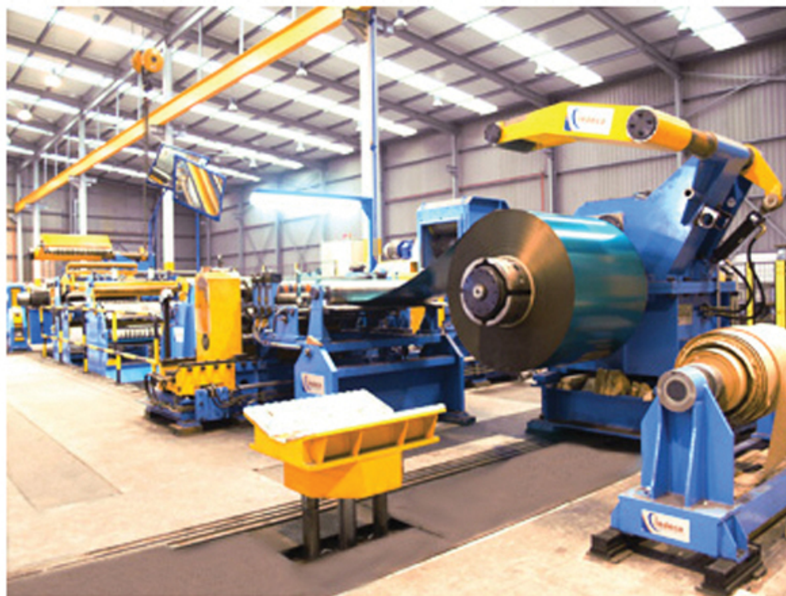
7.- Ligne de refendage de 1.250 mm. x 0,1mm. et 3 mm. x 350 m/min.
