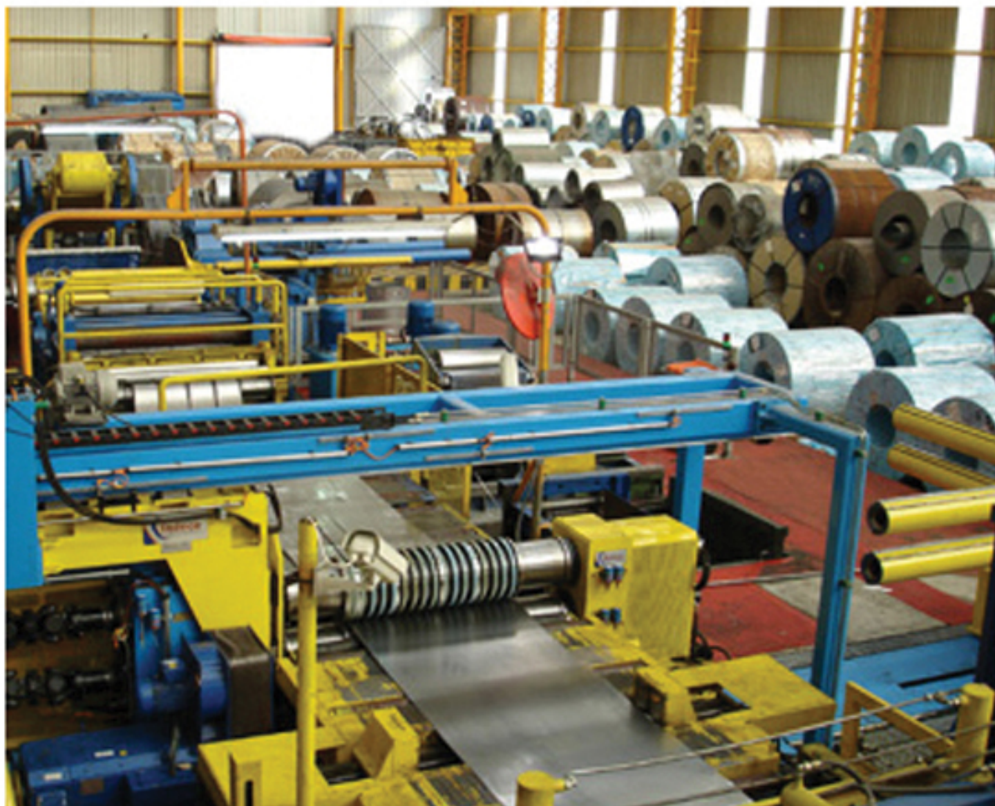
18.- Ligne de refendage pour Acier de 1500 mm. x 8 mm. x 250 m/min.
