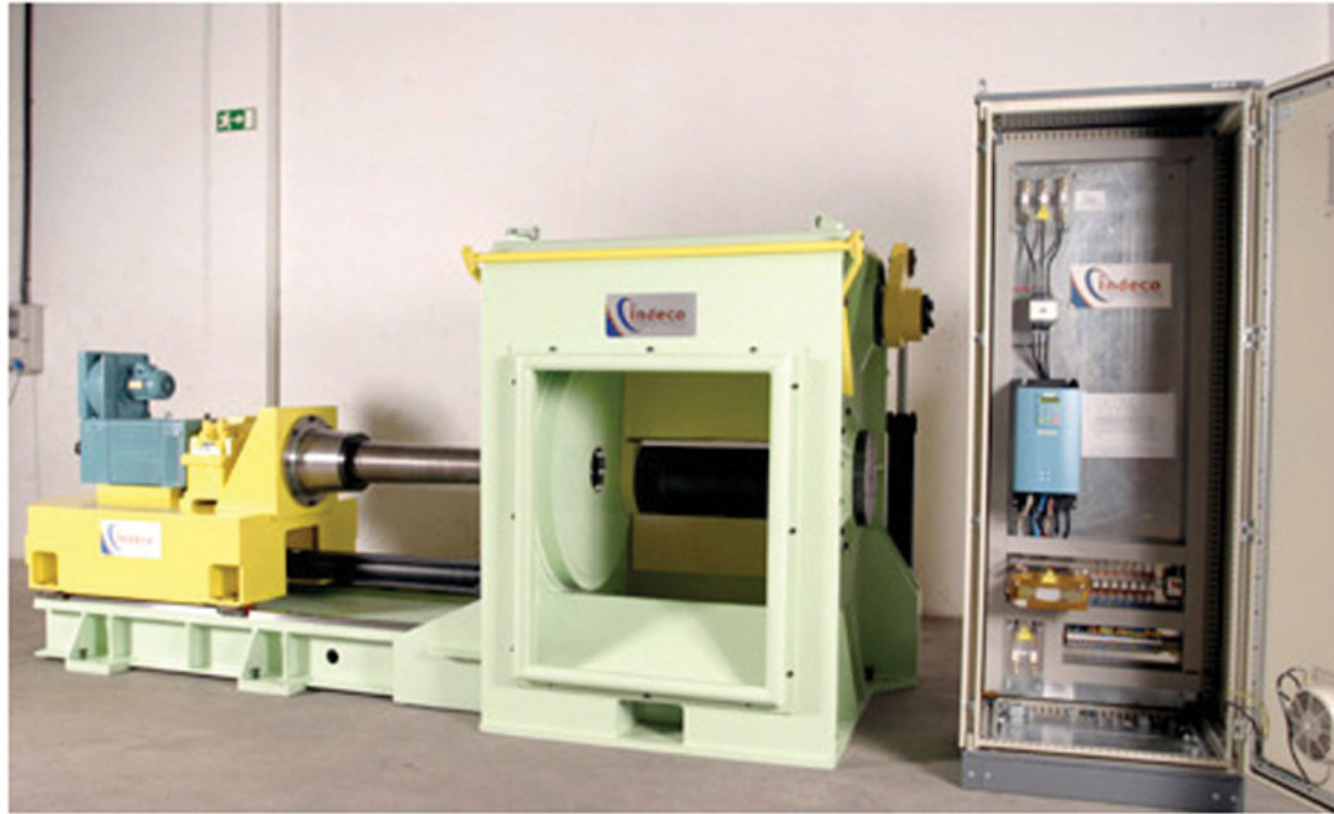
16.- Machine enrouleur de rives de 4 mm. d'épaisseur, en acier inox, avec son armoire de contrôle .
