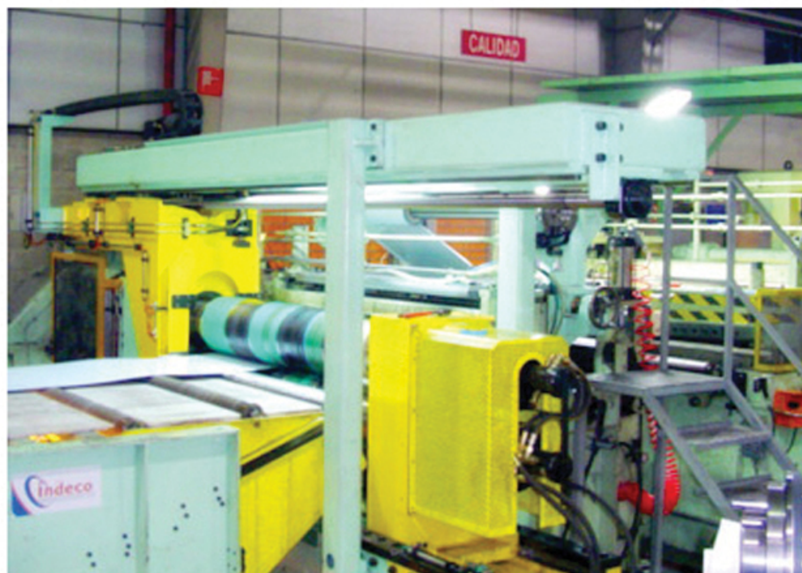
9.- Ligne de Refendage pour bandes en acier inox de largeur de 1500 mm. et épaisseur entre 0,1 et 3 mm.
