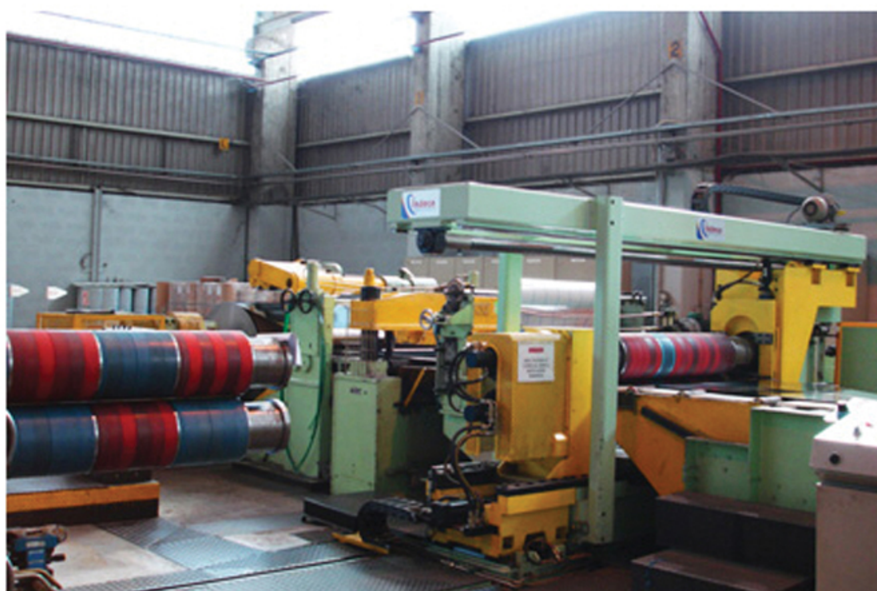
10.- Ligne de refendage pour Inox de 1500 mm. x 3 mm. x 150 m/min.
