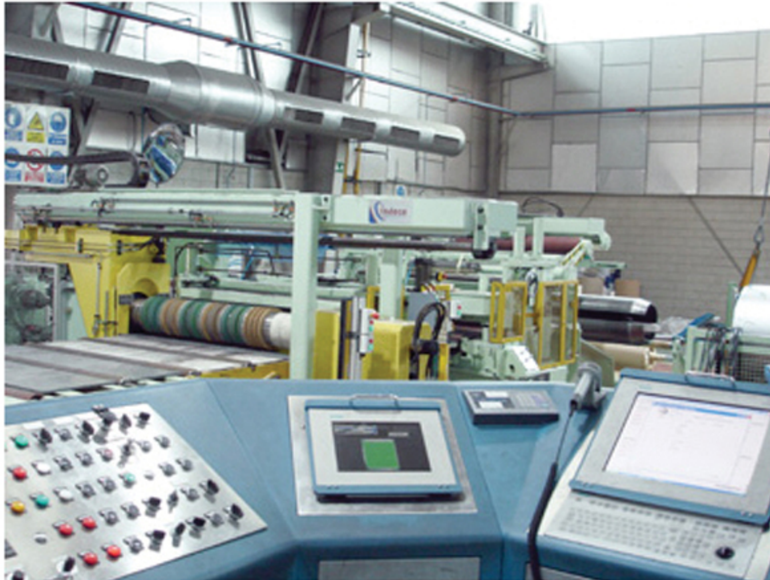
5.- Ligne de refendage pour Inox de 1500 mm. x 3 mm. x 150 m/min.
