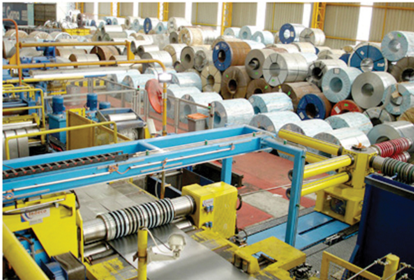
3.-Ligne d'Haute Production Type HPS de 1500 mm. x 8mm. x 150 m/min.
