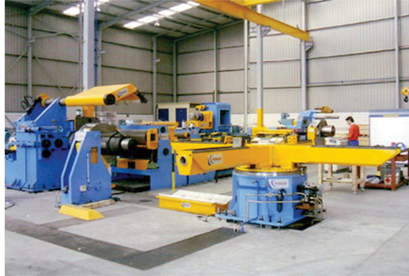
2.- Système Automatique pour déchargement de bobines avec tourelle a quatre bras et avec chariot pour bobineaux de poids 10 t.
